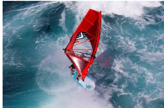
S-3 のデザインはブーム下のバテンを採用したことにより、トップに重さを感じることなく、それでいてはるかに短く、軽いフットバテンとなっている。そして、適度なアスペクト比を採用し、最高の軽さに感じることができる。また X プライラフパネルを採用したことで、少ないバテンでもセイルに程よい固さを出すことができ、セイルの安定感を増すことができた。
